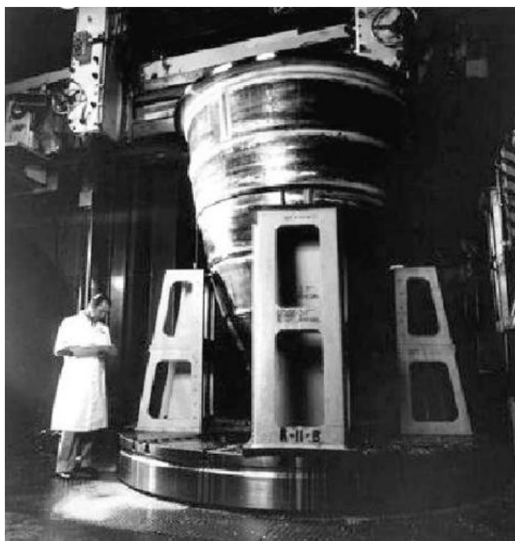
شکل ۱۸ یک قالب شکل‌دهی انفجاری شکل داده شده، جوشکاری شده و ماشینکاری شده.
