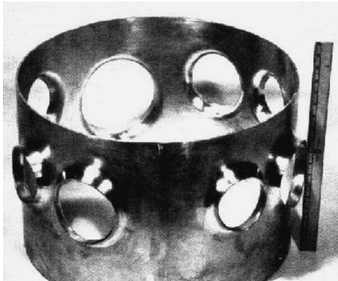
شکل ۱۶ قطعه استوانه‌ای از آلیاژ آلومینیوم 5052 H32 که به روش انفجاری لبه‌دار شده است.
